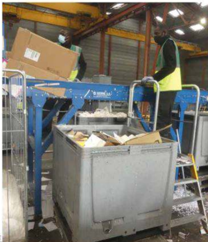
^ La ligne de tri des papiers-cartons : le bac de réception des matières triées repose sur des pesons pour un résultat avec une précision de 200 g.
